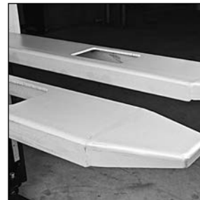
Punte delle forche che consentono un ingresso senza sobbalzi
