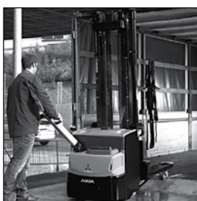
Sollevamento iniziale per le rampe
