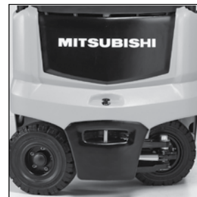
Assale posteriore che sterza completamente a 100°
