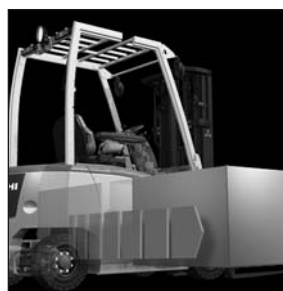
Sistema laterale per la sostituzione della batteria.
