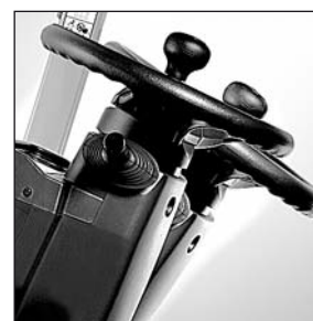
Piantone dello sterzo regolabile
