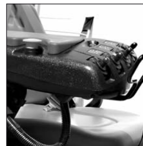
Comandi idraulici a sfioramento (opzionali)
