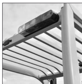
Tettuccio di protezione con chiara visuale
