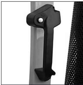
Maniglia e pulsante dell'allarme in retromarcia (opzionale)
