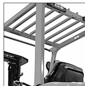
Tettuccio di protezione a chiara visuale
